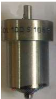
Gambar 5. Nozzle yang berkerak
